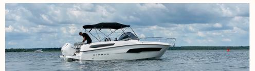
Länge über alles: 7,80m I Breite: 2,45m I max. Tiefgang: 0,38 m I Material Rumpf: GFK
